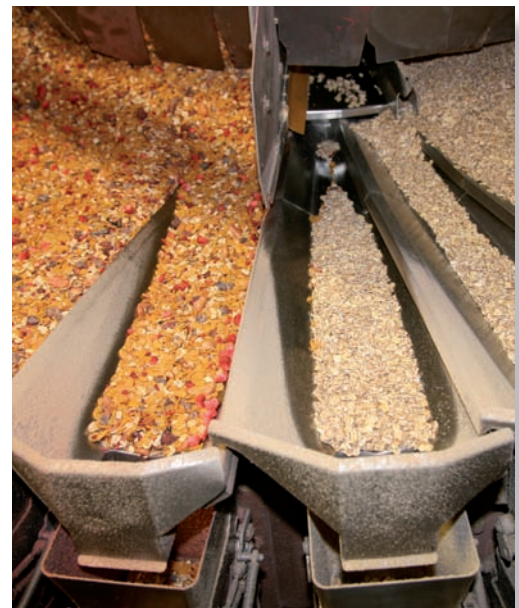
Die Waage ist mit einer 4-fach Produkttrennung im Bereich der Produktzuführung ausgestattet.
