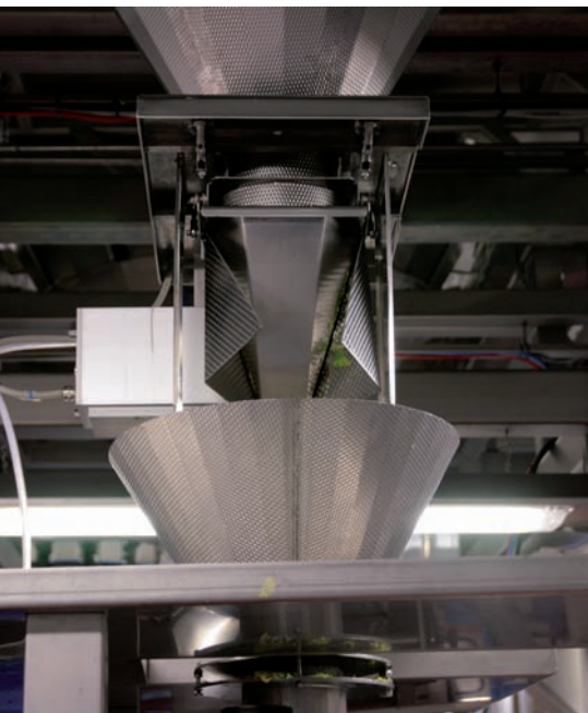
Ein spezieller Sammelbehälter sorgt für die perfekte Übergabe der Portionen an die Verpackungsmaschine.
